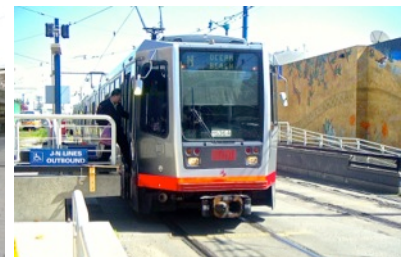
Tramway à plancher haut de San Francisco avec son quai d'embarquement de 86 cm .
